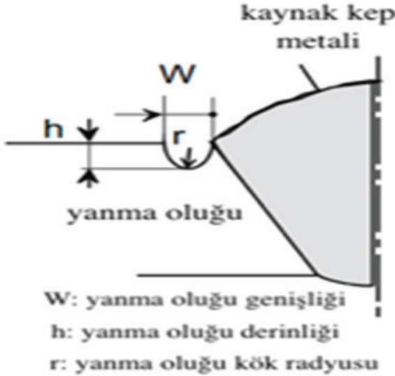
Şekil 4. Kaynak Birleştirmesinde (alın) Meydana Gelen Yanma Oluğunun Önemli Kesit Değişkenlerinin Tanımı [Cerit vd., 2010]
