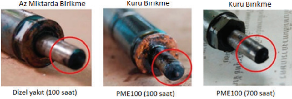
Şekil 6. Yakıt Enjektörü Üzerindeki Karbon Birikimi (Suthisripok ve Semsamran, 2018)
