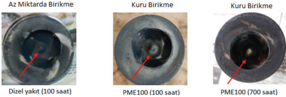
Şekil 3. Piston Üzerindeki Karbon Birikimi (Suthisripok ve Semsamran, 2018)
