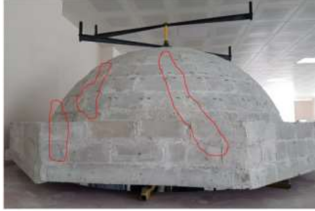
Şekil 3. EM Deney Numunesi ve Tamir Harcı Uygulanan Bölgeler
