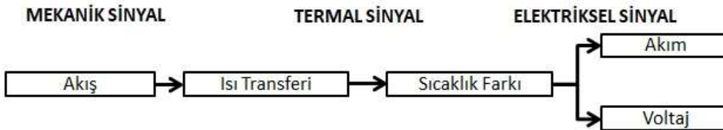
Şekil 2. Isıl Kütleli Akış Ölçer Sinyal Aktarım Süreci
