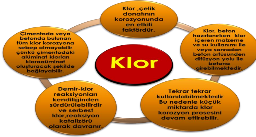
Şekil 4. Beton Yapılarda Klorun Donatı Korozyonuna Etkisi
