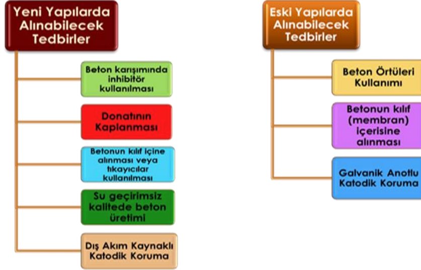
Şekil 5. Beton Yapılarda Korozyon Hasarı için Önlemler
