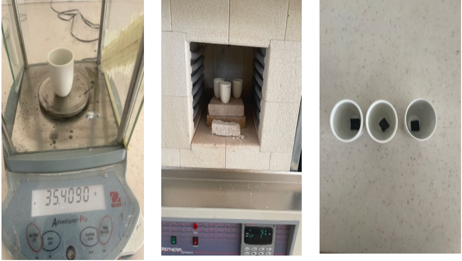
Şekil 4. Kül Fırınında Kompozit Plakalardan Alınan Numuneler Üzerinde Yanma Testi
