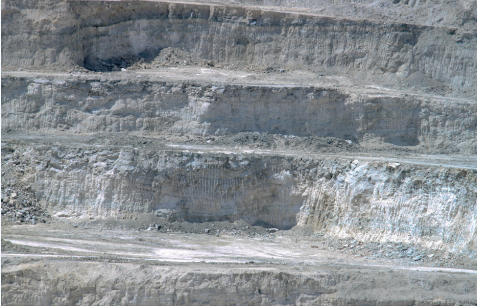
Fotoğraf 1. Açık Saha Madenciliğinde Ayna ve Yatakların Konumlandırılması
